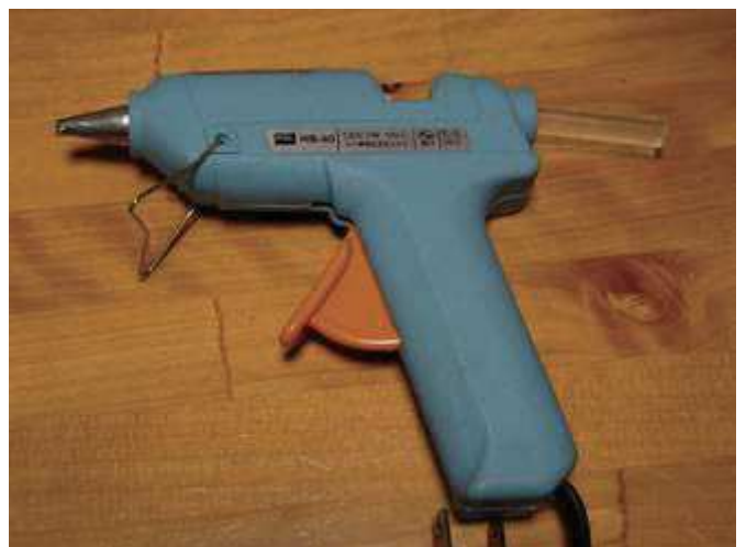
12. クラフトで活躍する道具その3 ホットボンド 右側に飛び出ている透明の樹脂の棒が熱で溶かされ、左の小さな口から接着剤として出てきます。小枝同士の接着や木の実の接着など、接着しにくいものに使用することができます。
